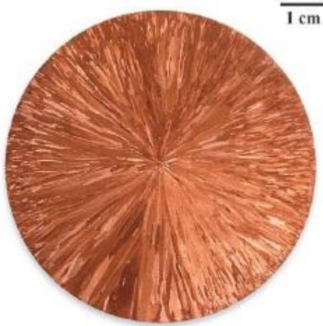
Şekil 1. Merkezden dışarı doğru uzanan iğne şeklinde tanelerin görüldüğü silindirik bir bakır ingot kesiti.
