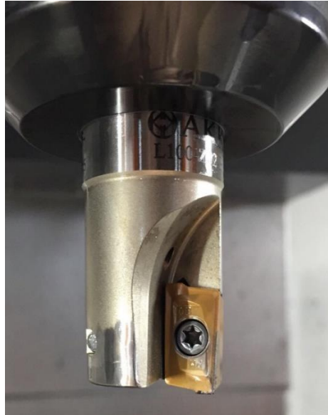
Şekil 6. Deneylerde kullanılan kesici uç ve tutucu takım
